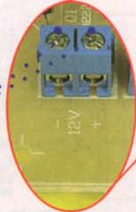
Figura 2.6. Finalmente suelde los conectores y el relé
