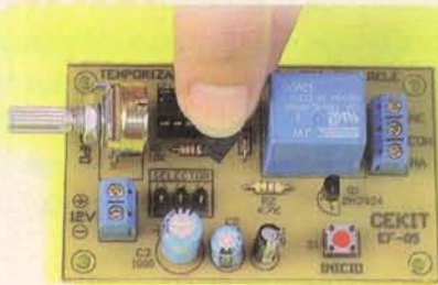
Instalación del puente o jumper según el rango de tiempo necesario
