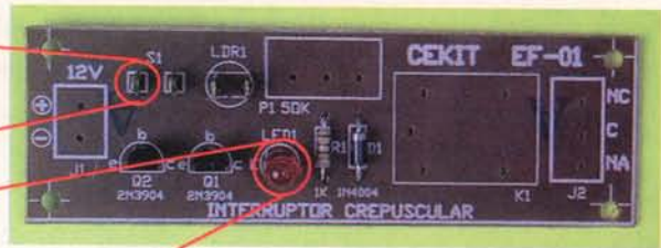
Figura 1.5. Luego suelde los transistores y el diodo LED. En aquellos puntos donde se conectan componentes que pueden ser ubicados en el chasis y conectados mediante cables, se deben colocar espadines para así facilitar la soldadura de los mismos.
