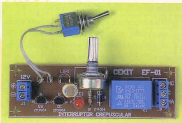
Figura 1.6. Seguidamente suelde los componentes de mayor altura como son los conectores de 2 y de 3 tornillos, el potenciómetro y el relé.
